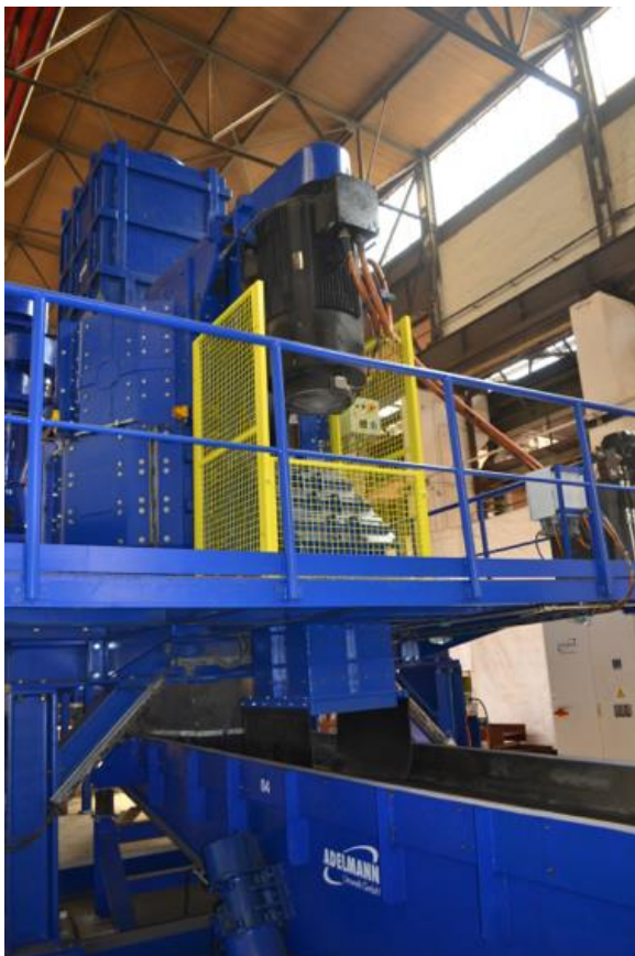
Abb.: AVB mit Vibrationsrinne
